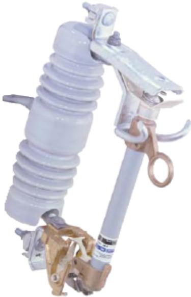
Estilo Aéreo Montado en Postes de Carga Extra Pesada, con capacidad de 14.4 kV nominales, 15 kV máximos, 110 kV NBAI, 100 amperes continuos, 10,000 amperes de interrupción RMS asimétrica, distancia de fuga mínima a tierra de 8 1/2 pulgadas (216 mm).
