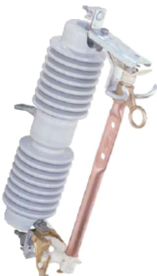
Estilo Aéreo Montado en Poste, Desconectador, con capacidad de 25 kV nominales, 27 kV máximos, 150 kV NBAI, 300 amperes continuos, distancia de fuga mínima a tierra de 26 pulgadas (660 mm).
