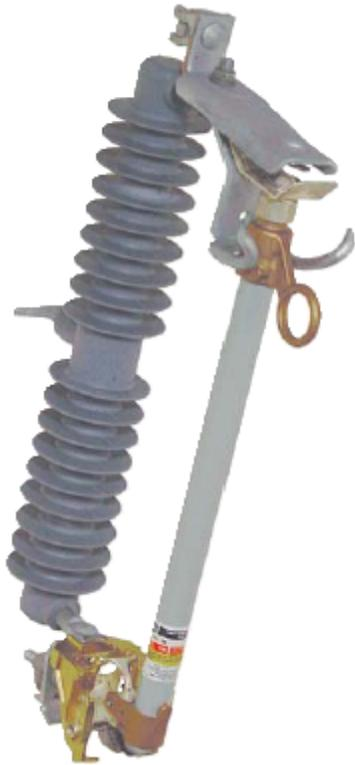
Estilo Aéreo Montado en Postes de Carga Ultra Pesada, con capacidad de 25 kVj nominales, 27 kV máximos, 150 kV NBAI, 100 amperes continuos, 12,000 amperes de interrupción RMS asimétrica, distancia de fuga mínima a tierra de 30 pulgadas (762 mm).
