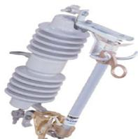
Estilo Aéreo Montado en Postes de Carga Extra Pesada, con capacidad de 25 kVn nominales, 27 kV máximos, 150 kV NBAI, 100 amperes continuos, 8,000 amperes de interrupción RMS asimétrica, distancia de fuga mínima a tierra de 17 pulgadas (432 mm).1
