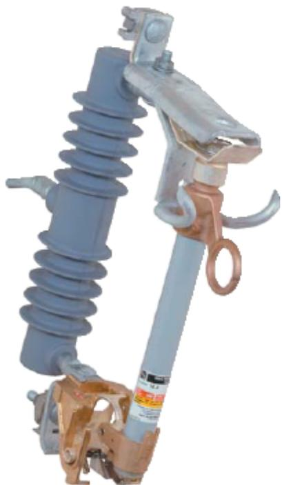
Estilo Aéreo Montado en Postes de Carga Ultra Pesada, con capacidad de 14.4 kV nominales, 15 kV máximos, 110 kV NBAI, 100 amperes continuos, 16,000 amperes de interrupción RMS asimétrica, distancia de fuga mínima a tierra de 8 ½ pulgadas (216 mm).
