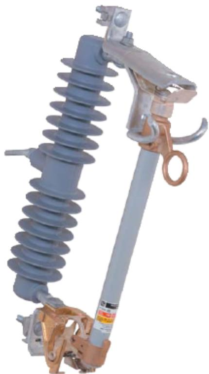
Estilo Aéreo Montado en Postes de Carga Ultra Pesada, con capacidad de 25 kVd nominales, 27 kV máximos, 150 kV NBAI, 100 amperes continuos, 12,000 amperes de interrupción RMS asimétrica (16,000 amperes en un solo tiro), distancia de fuga mínima a tierra de 17 pulgadas (432 mm).
