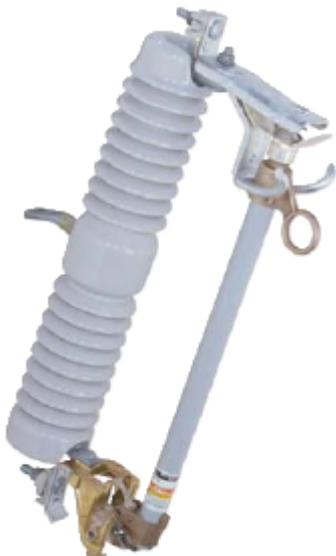
Estilo Aéreo Montado en Postes de Carga Ultra Pesada, con capacidad de 25 kVn nominales, 27 kV máximos, 150 kV NBAI, 100 amperes continuos, 12,000 amperes de interrupción RMS asimétrica, distancia de fuga mínima a tierra de 17 pulgadas (432 mm).
