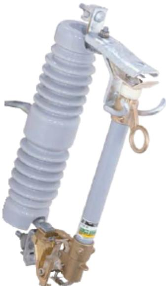
Estilo Aéreo Montado en Postes de Carga Ultra Pesada, con capacidad de 25 kV nominales, 27 kV máximos, 125 kV NBAI, 200 amperes continuos, 10,000 amperes de interrupción RMS asimétrica, distancia de fuga mínima a tierra de 11 pulgadas (279 mm).
